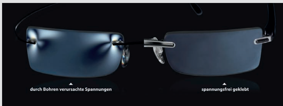
Polarisiertes Licht macht die Spannungszustände im Glas sichtbar. Der Vergleich mit der gebohrten Brille (links) zeigt, dass die Klebeverbindungen (rechts) keine Spannungen ins Glas einleiten (Bilder: Lensbond)
